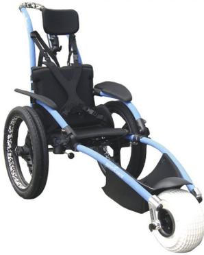
Conçu pour rouler sur le sable, et pouvant aller dans l'eau, il permet de transporter une personne à mobilité jusque dans l'eau. Comme il ne flotte que très peu, il peut être immerger facilement permettant à la personne qui y est assise d'en sortir facilement grâce à la poussée de l'eau.
